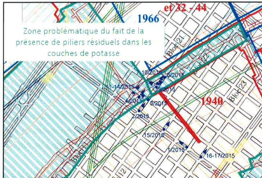
Figure 11 Zone sud-ouest du bloc 21 , située dans le périmètre de la portion de gisement abandonnée, et situation d'exploitation des veines de potasse sus-jacentes.
