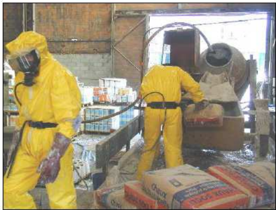
Les bidons sont découpés, et l'arsénite est vidée dans le malaxeur avec de la chaux
