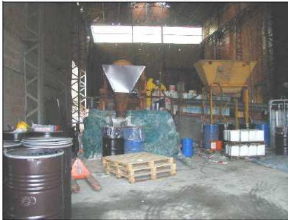
Le mélange chaux/arsénite de soude, est ensuite conditionné en fûts de 200 l
