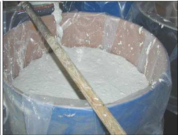
Le mélange chaux/arsénite de soude, est ensuite conditionné en fûts de 200 l
