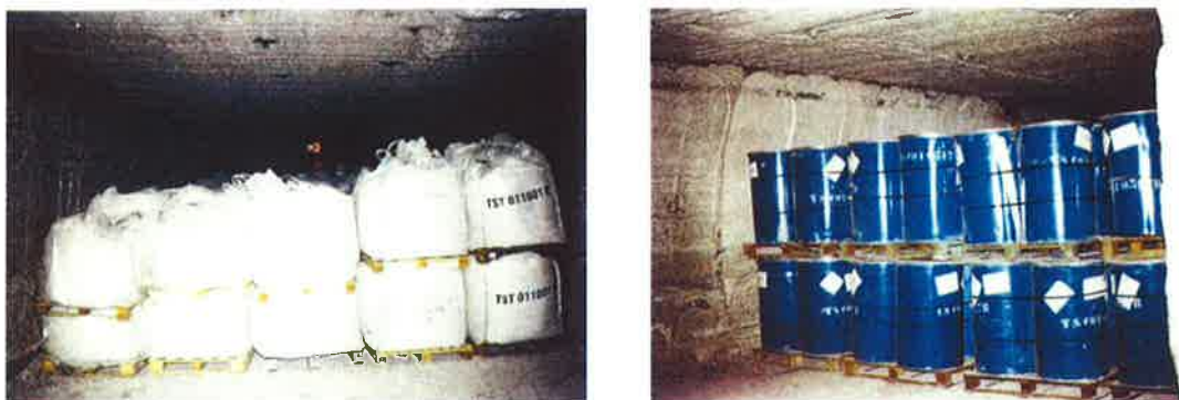
Figure 29. Stockage des déchets en big-bags (à g.) et en fûts (à d.) [MICA, 2008]
