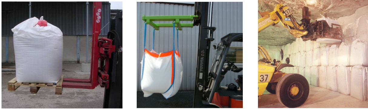
Fig. 28 Saisie des big-bags avec une fourche (à gauche, exemple quelconque), par les oreilles (au centre, exemple quelconque) puis avec une pince (à droite, exemple de la mine d'Herfa-Neurode en Allemagne)
