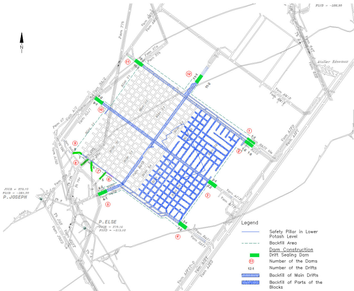
Fig. 36 Vue d'ensemble sur la localisation des barrages et des galeries à remplir selon ERCOSPLAN (Confinement après Variante I-b)
