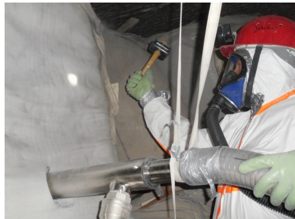
Photos 14 : opérations d'aspiration d'un big-bag
