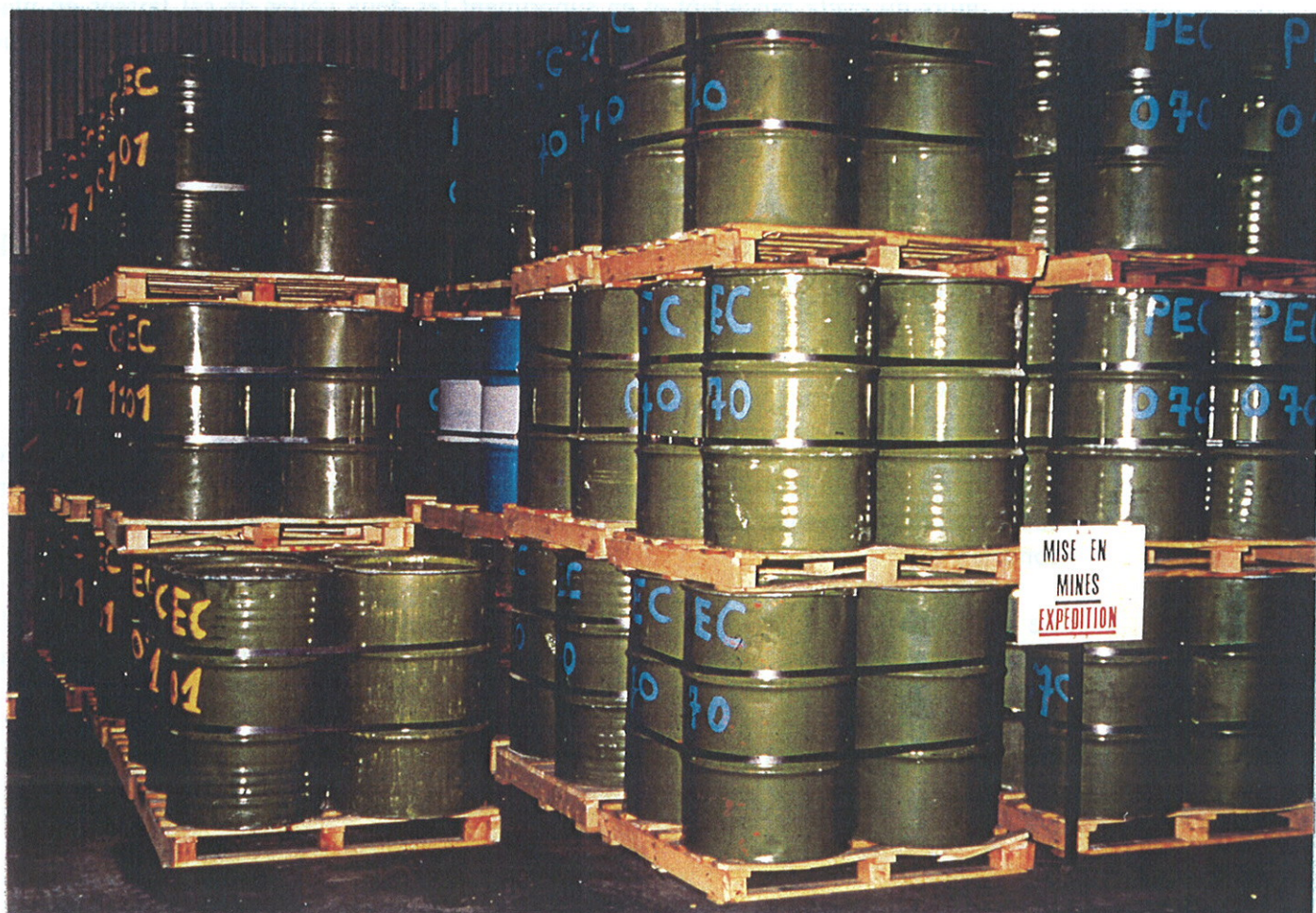
Déchets conditionnés pour descente en mine
