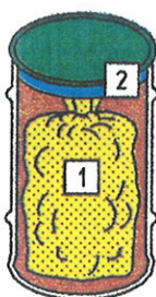
1. Déchets 2. Bouchon en plâtre
