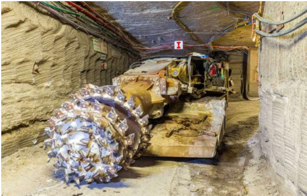
Figure 72 - Excavatrice à attaque ponctuelle PAURAT
