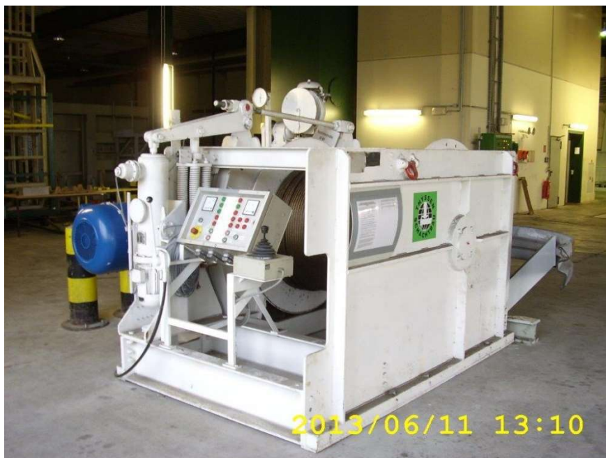
Figure 11 - Treuil semi-mobile utilisé sur le site de Gorleben
