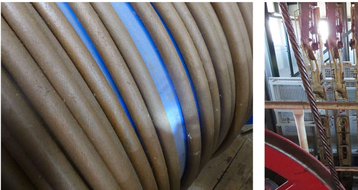
Figure 2 - Photographie des câbles clos sur le site des MDPA (gauche) et photographie des câbles à torons utilisés sur le site de Gorleben en Allemagne (droite)
