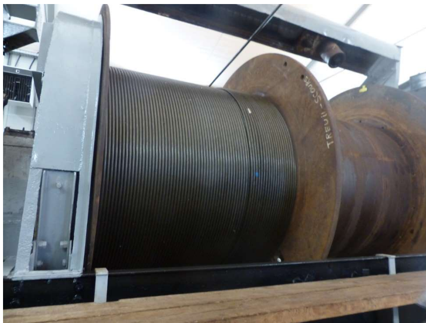
Figure 3 - Treuil à friction utilisé comme secours pour le puits Joseph
