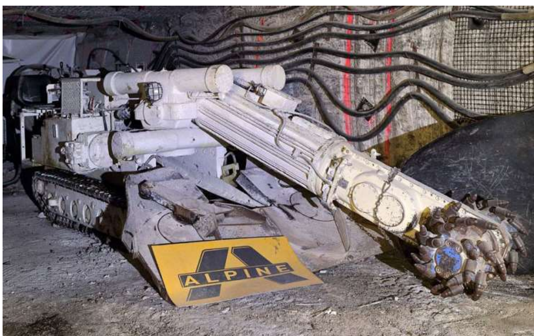
Figure 73 - Excavatrice à attaque ponctuelle Alpine F6a
