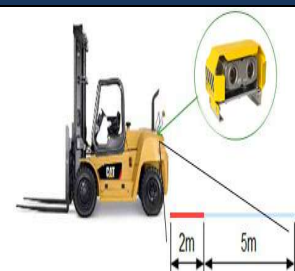
Système de détection anticollision
