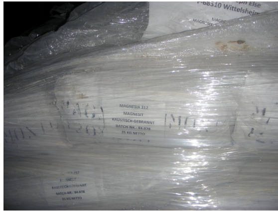
Ciment magnésien classiquement utilisé pour l'étanchéification de sondages dans les mines de sel
