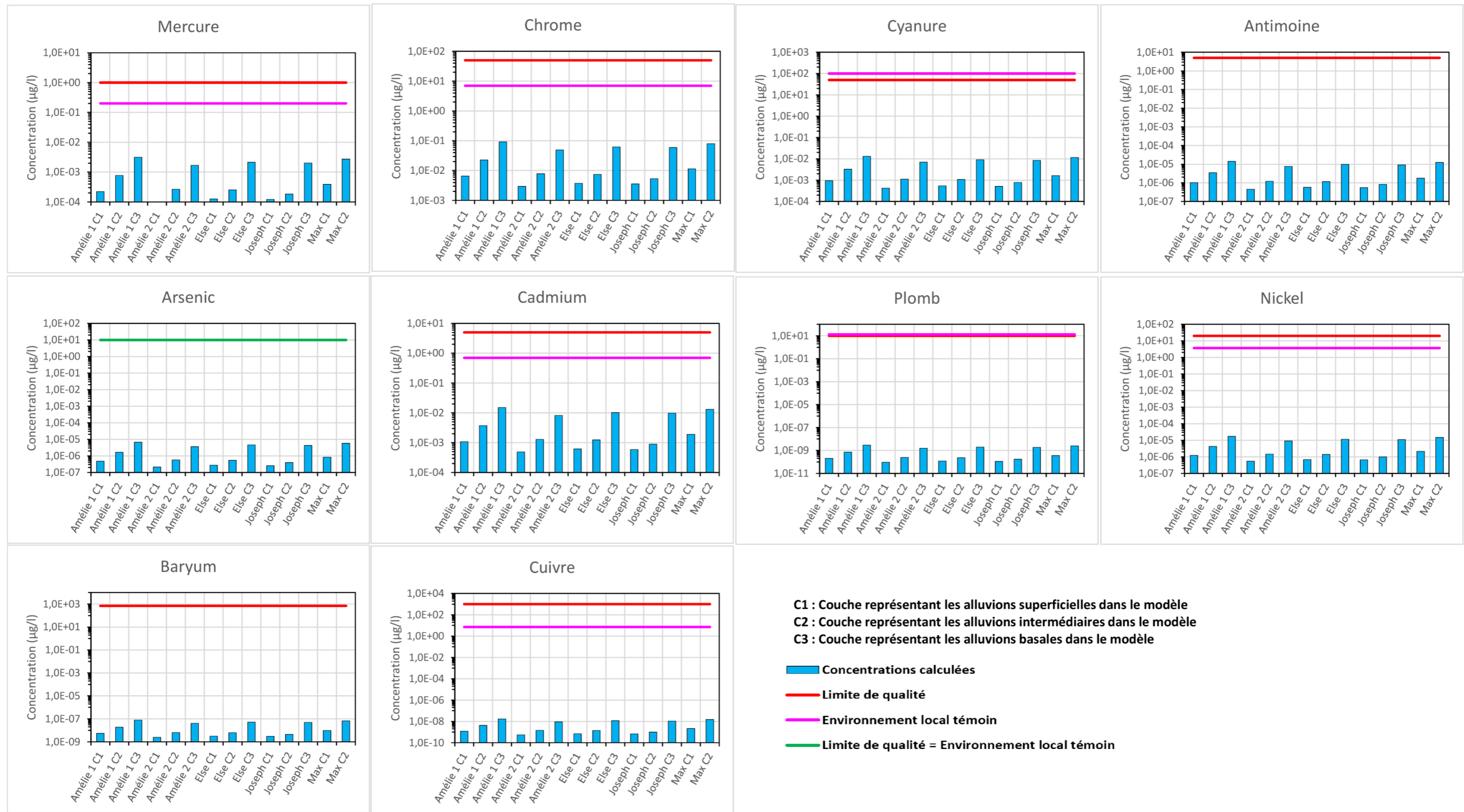
Figure 75 : Concentrations moyennes en Hg, Cr, Sb, As, Cd, Pb, Ni, Ba, Cu, calculées selon le scénario dit « 93 % » au droit des 5 puits de mine dans les 3 couches du modèle du BRGM au temps t = t_0 + 1\,300 ans (avec t_0 la date de mise en place des barrages de confinement) et comparaison à l'environnement local témoin et aux limites de qualité pour une eau de consommation humaine
