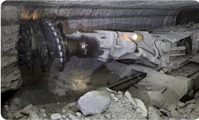
> Réalésage du toit instable avec la machine Paurat.
