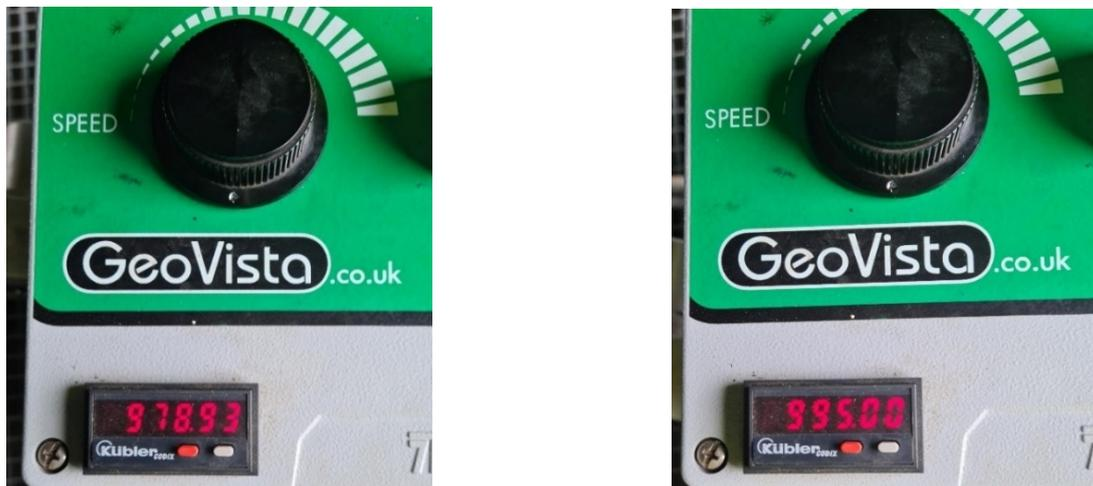
Photo 6. Mesures de profondeur affichées sur le compteur métrique du treuil lorsque la sonde touche le niveau fluide du forage VL-PB2 (à gauche) et lorsqu'elle arrive à la profondeur voulue (à droite)
