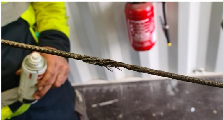
*Photo 4. Vue d'une zone fortement corrodée sur le câble du VA-PB2*
