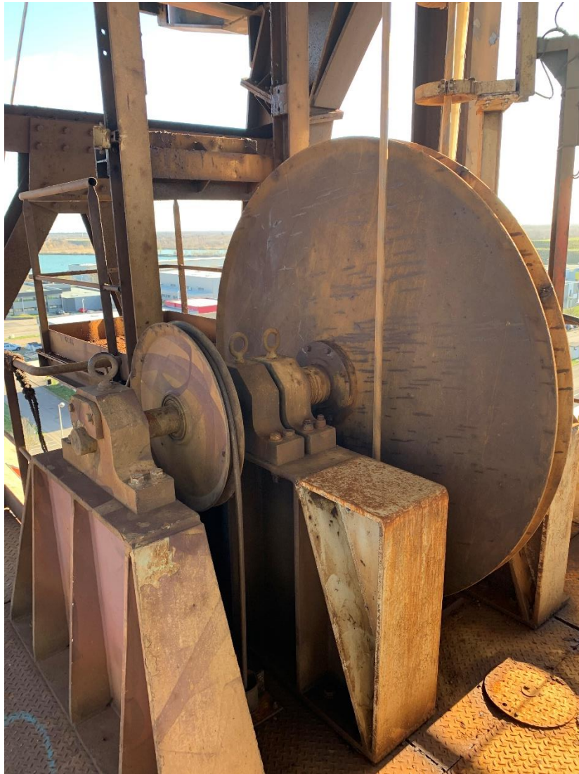
Figure 15 : Poulie de treuil 4T (gauche) et 25T (droite)
