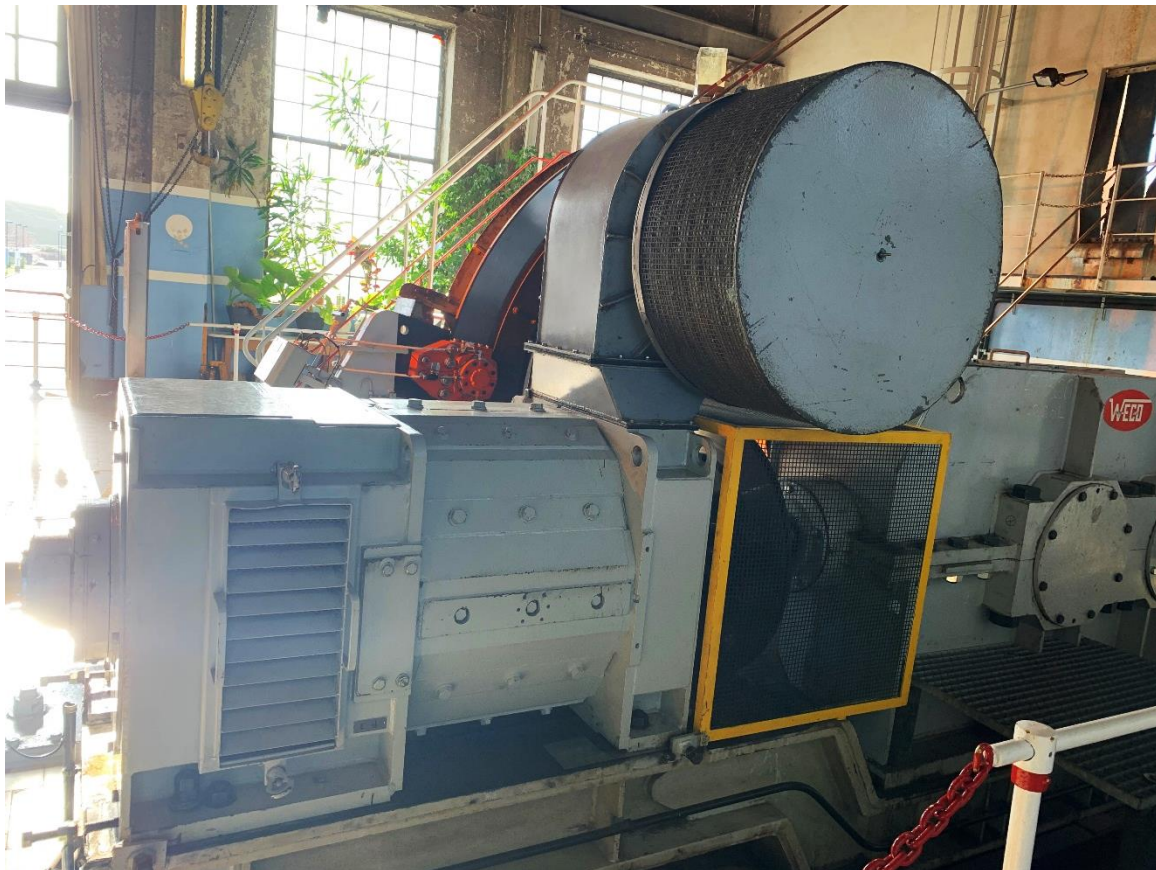
Figure 20 : Moteur Alsthom DC 460V 478KW
