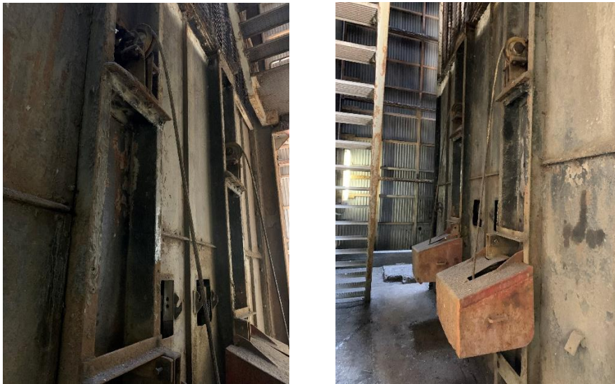
Figure 7 ; Dispositif d'ouverture-fermeture du plancher de travail
