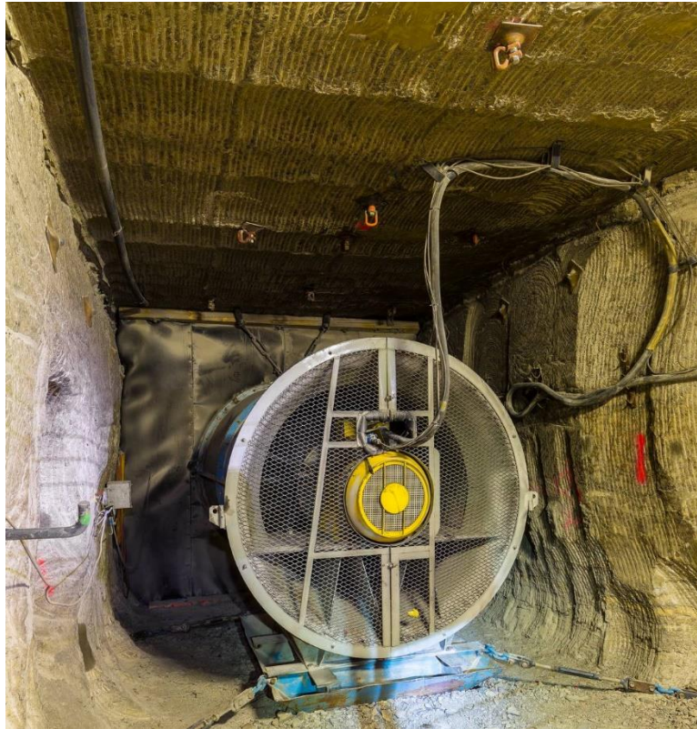
Figure 19 : Ventilateur principal
