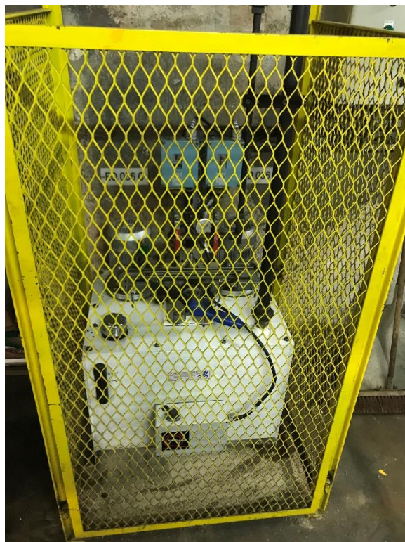
Figure 23 : Centrale hydraulique de graissage des paliers - Vue d'ensemble
