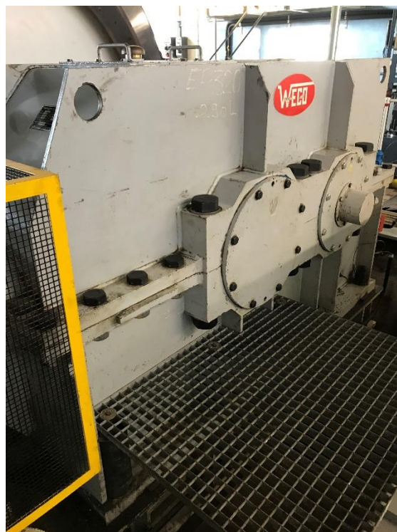
Figure 21 : Vue reducteur 478kW du moteur DC
