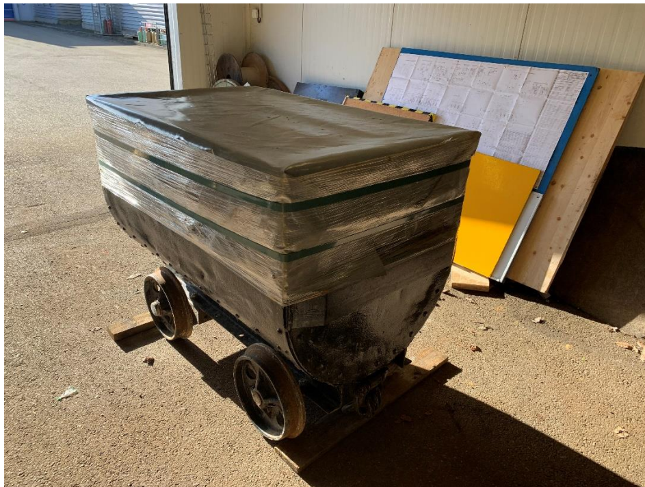
Figure 5 : Poids étalon pour essais cage en charge 4T
