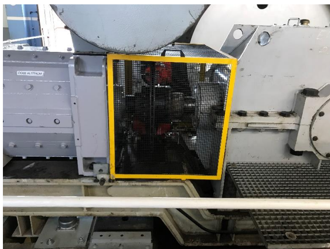
Figure 25 : Frein grande vitesse et accouplement moteur-réducteur (gauche) – Vue d'ensemble frein (droite)
