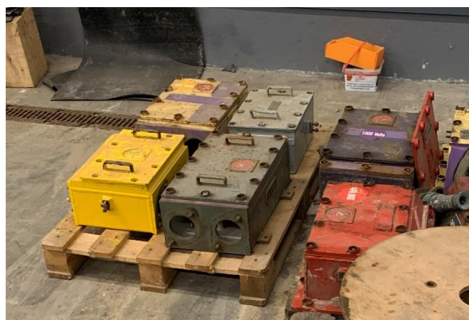
Figure 57 : Boîtes de jonction BDA
