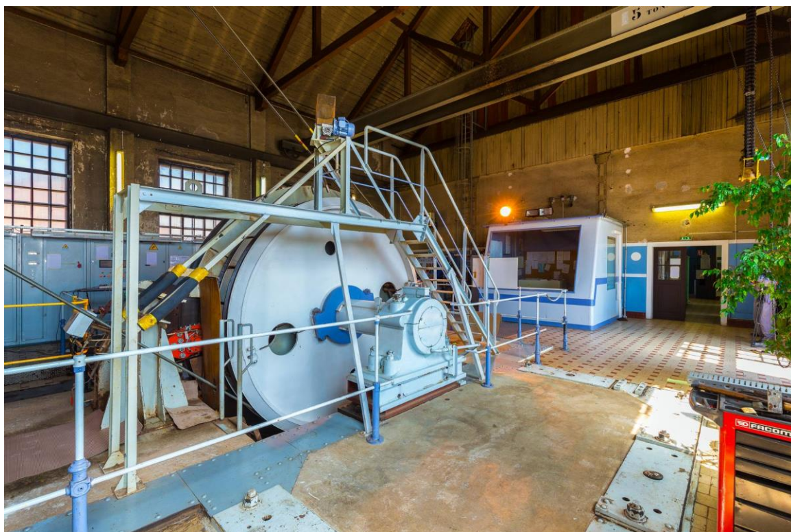
Figure 19 : Vue d'ensemble de la poulie Koepe et cabine machiniste
