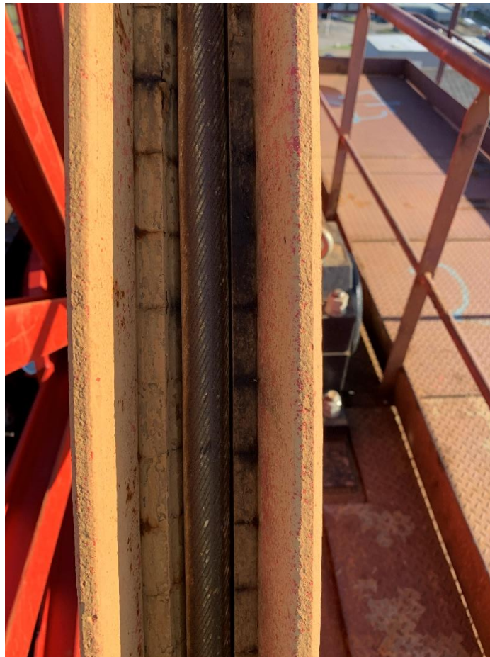
Figure 13 : Molette supérieure Joseph - Garniture Beckorit
